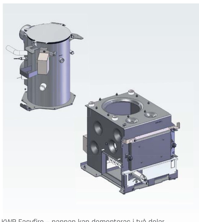
KWB Easyfire – pannan kan demonteras i två delar
