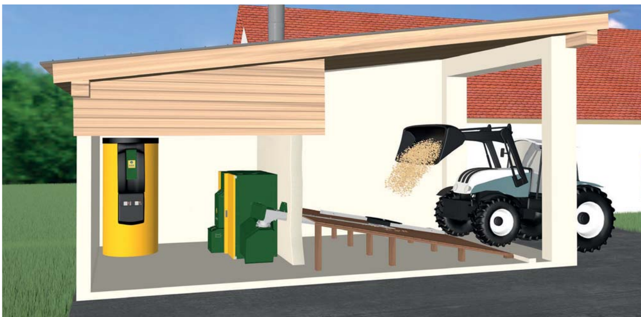
KWB Multifire med fjäderomrörare och transportskruv; direktyllning till förrådet.
