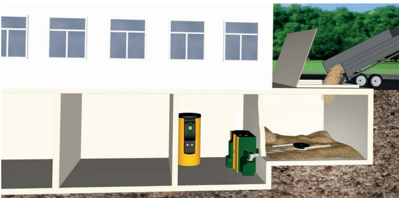
KWB Multifire med omrörare och transportskruv; direktyllning till förråd.
